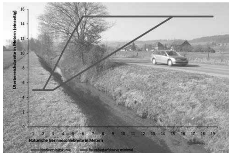
Fig. 16 Inclinazione corretta di un argine incassato nel piano di campagna. Tratto da http://www.cscf.ch
